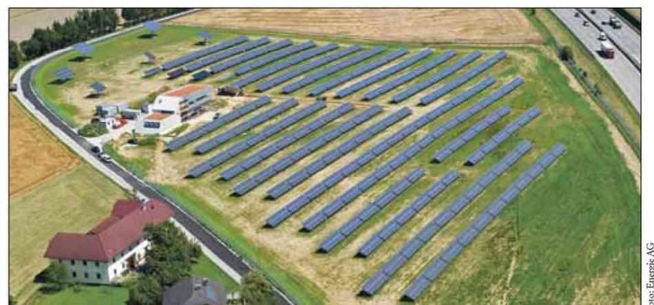
**Nicht zu übersehen: An der Autobahn A1 bei Eberstalzell in Oberösterreich liefert eine Photovoltaikanlage mit 8.000 m<sup>2</sup> pro Jahr bis zu 1.000 MWh Strom ins Netz.**
