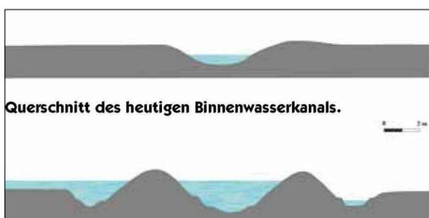
Rekonstruierter Querschnitt desselben Kanals aus der Árpádenzeit.
