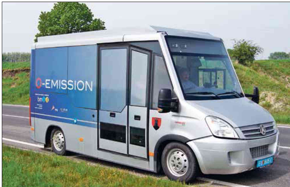
Seit kurzem dreht ein Solarbus in der Gemeinde Hornstein seine abgasfreien Runden. Weil seine Batterien schnell austauschbar sind, entfällt die Wartezeit beim Laden.
