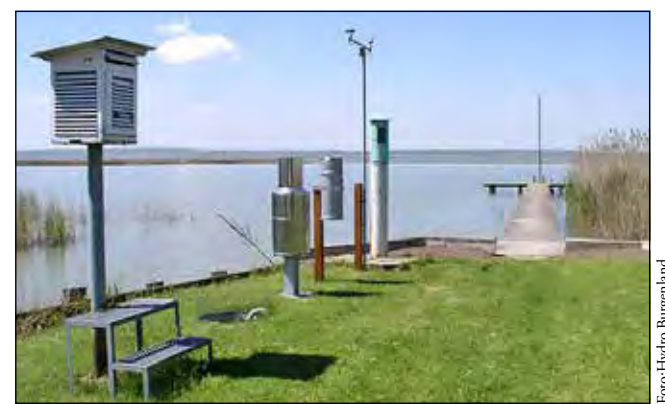
Kombinierte Niederschlags-, Verdunstungs- und Pegelstation bei der Biologische Station Neusiedler See.
