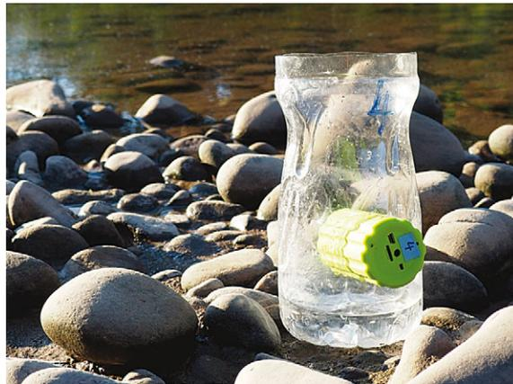
**Abb. 1:** Akustische Falle. Die Falle wurden aus einer 2,5 Liter Flasche mit abgeschnittenem Flaschenhals und einem seitlichen Loch, durch das der Lautsprecher geführt wurde, gebaut. Die Flasche wurde ca. 3-5 cm hoch mit spülmittelhaltigem Wasser gefüllt.
