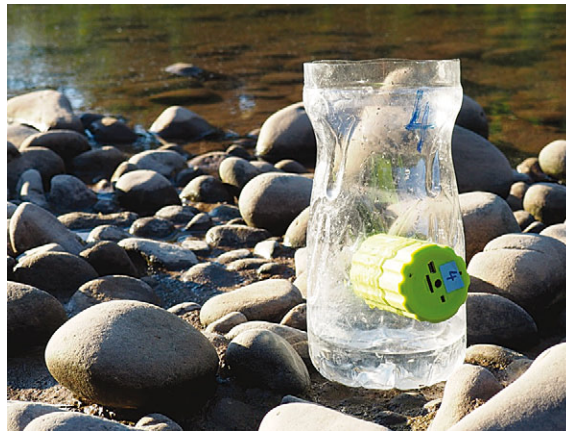
Abb. 1: Akustische Falle. Die Falle wurden aus einer 2,5 Liter Flasche mit abgeschnittenem Flaschenhals und einem seitlichen Loch, durch das der Lautsprecher geführt wurde, gebaut. Die Flasche wurde ca. 3-5 cm hoch mit spülmittelhaltigem Wasser gefüllt.
