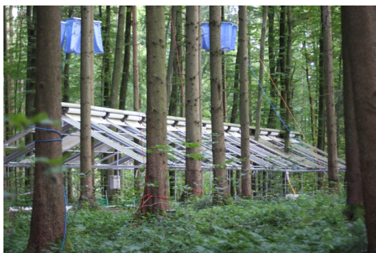
Abb. 1. Eine Dachfläche im geöffneten Zustand. Die Dächer schließen automatisch bei Niederschlag und halten damit insgesamt 70 % des Jahresniederschlags während der Vegetationsperiode von den Flächen ab (Foto: T. Grams).
