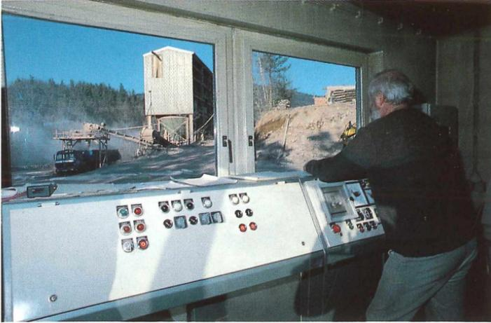
**Abb. 59:** Blick durch das Fenster des Waage-Häuschens auf die Silo- und LKW-Verladeanlage. Im Vordergrund ist das Steuerpult für die Anlage zu sehen. Der Mitarbeiter H. KUNKEL ist gerade dabei (01.02.1991), einen LKW zu beladen.
