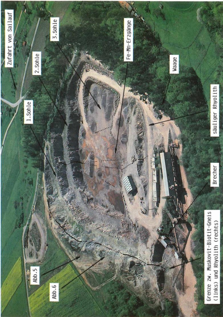
**Abb. 3:** Der zur Zeit dreisohlige Steinbruch an der Hartkoppe bei Sallauf von Nordwesten gesehen. Die Fahrzeughalle oberhalb der Siloanlage wurde inzwischen auf die Fläche am linken, unteren Bildrand verlagert. Mit durchgezogenen Linien wurden sichtbare, mit punktierten Linien wurden nachgewiesene Störungen bzw. Grenzen überzeichnet. Aufgenommen am 29.04.1990 aus ca. 200 m Höhe, Freigegeben Reg. v. MFR -Luftamt Nordbayern - Nummer P4186/4.
