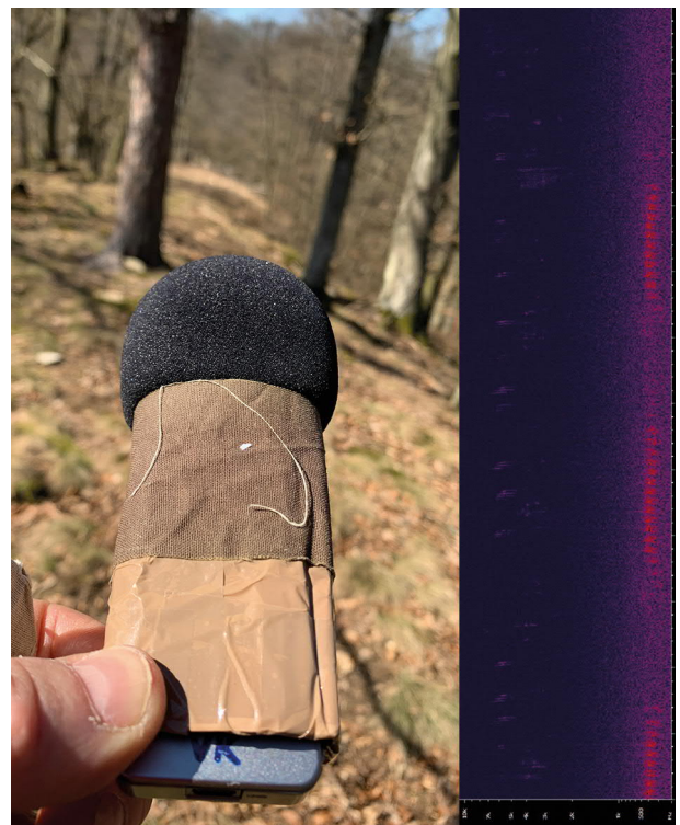
Abb. 5: Wetterfest verpackter Rekorder (Diktaphone der Firma Olympus) und ein Beispiel für den über ein Spektrogramm visualisierten Ruf einer Hohлтаube (Aufnahme vom 9. April 2020, 12:29, Rekorder VG beim Heimatkreuz).
