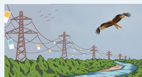
Die Projektgrafik zeigt Schutzfahnen an Stromleitungen zur Bewahrung der Vögel vor Kollision.
