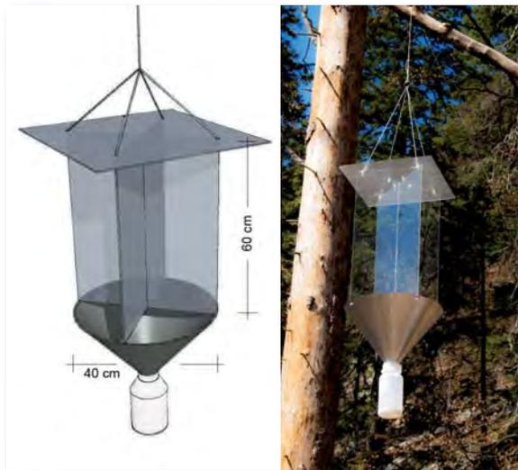
Abb. 11 - Kreuzfensterfalle: links Zeichnung, rechts Falle in der Untersuchungsfläche Zwielauf.
