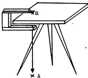
Jetzt peilt man den Punkt B der Standlinie mit dem Visierlineal an. Man legt die Linealkante an Punkt a auf dem Papier an und wenn B eingepielt ist, zeichnet man diese Richtungslinie an der Linealkante ein.
