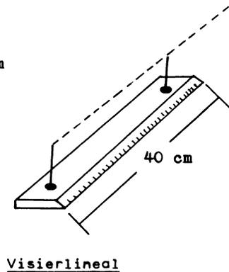
Das Prinzip der Messung ist eine einfache Dreieckspeilung. Im zu kartierenden Geländeabschnitt wird zunächst eine sogenannte Standlinie mit dem Meßband ausgemessen und an ihren beiden Endpunkten A und B mit je einer Meßlatte markiert.
