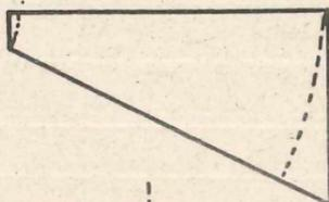
Die Stücke werden nun mit einer Nähmaschine zu einer Tüte zusammengenäht. Die Nähte sind als doppelte Nähte auszuführen, das heißt, jede Naht wird umgelegt und noch einmal vernäht. Man sollte möglichst feines synthetisches Garn verwenden. Die so erhaltene Tüte wird nun abgerundet (Abb.).
