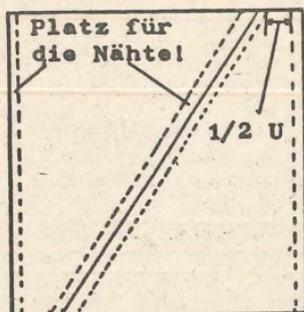
Planktonnetzgaze (Perlon- oder Nylonsieb-gaze) wird quadratemeterweise geliefert. Dieses Quadratemeterstück zerschneidet man verlustlos, z. B. in 12 Stücke 25 x 33 cm. Der Preis pro Quadratmeter beträgt ca. 80 DM, für jedes Stück also weniger als 10 DM. Jedes dieser Stücke wird zugeschnitten, wie es nebenstehende Abbildung zeigt. Dabei bedeutet U, Umfang des Sammelbechers. Im Schnitt muß Platz für die Nähte gelassen werden!
