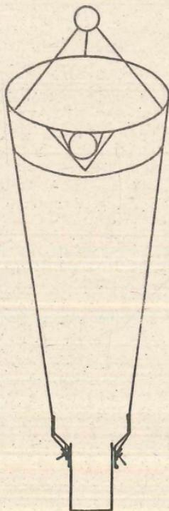
Ins untere Ende des Netzes wird ein Sammelbecher eingebunden. Dazu schneidet man eine 50ml-Weithalsflasche aus Polyäthylen auf (Abb.). Das so erhaltene Ansatzstück wird eingebunden. Es muß stramm sitzen (Abb.). In die verbleibende Öffnung steckt man ein im Durchmesser passendes Medikamentengläschen. Es wird nach jedem Fang ausgetauscht, dient also gleichzeitig der Aufbewahrung der Proben.
