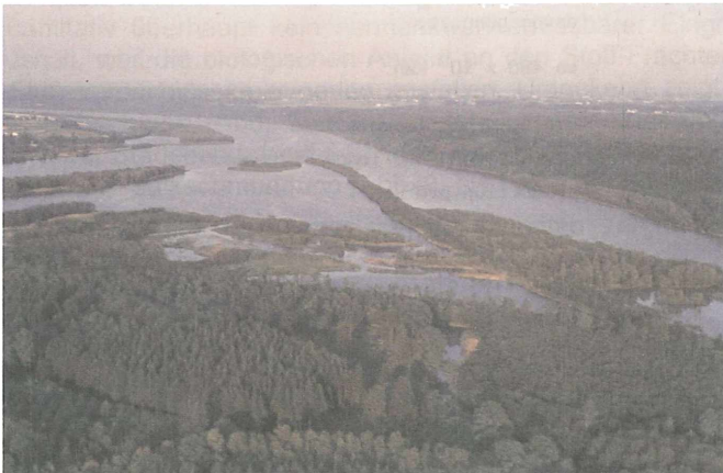
Abb. 2: die Entstehung eines „perfekt aussehenden“ Flußdeltas an der Salzachmündung als Folge der Einstaung
