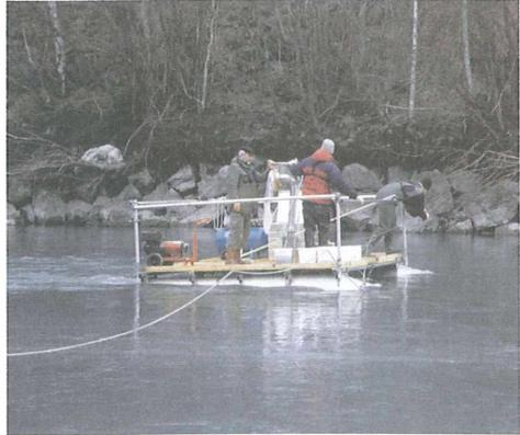
Abb. 5: Arbeitsplattform für Airlift-Probennahmen
