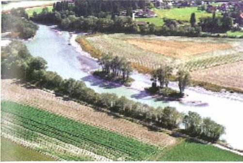
Abb. 18: Gegen Sohleintiefung - Die Aufweitung der Drau – rechtsufrig auf einer Länge von 1,5 km - wirkt der laufenden Eintiefung der Drausohle entgegen. Dies verbessert die Hochwassersicherheit und den Grundwasserhaushalt.
