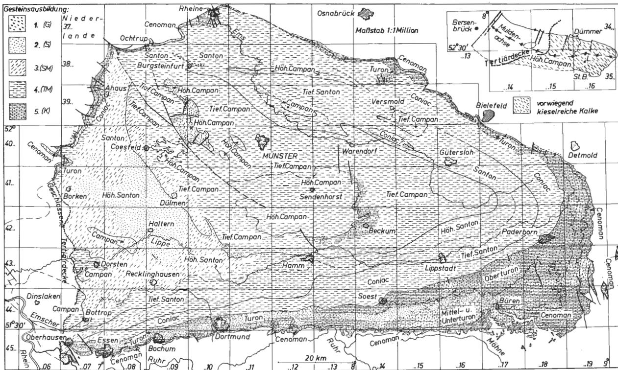
1 = Geröllhaltige Sedimente 2 = vorwiegend Sande 3 = Mergelsande bis Sandmergel 4 = vorwiegend Tonmergel 5 = vorwiegend Mergelkalkstein bis Kalkstein
