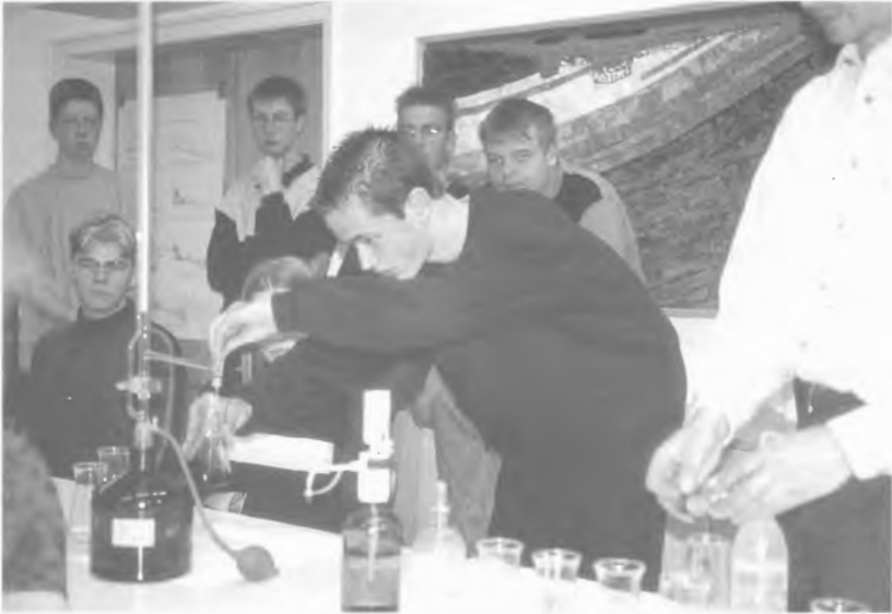
Abb. 1: Schüler in der Außenstelle „Heiliges Meer“ bei der Analyse der Wasserproben aus dem Großen Heiligen Meer (Bestimmung gelösten Sauerstoffs nach WINKLER 1888).
