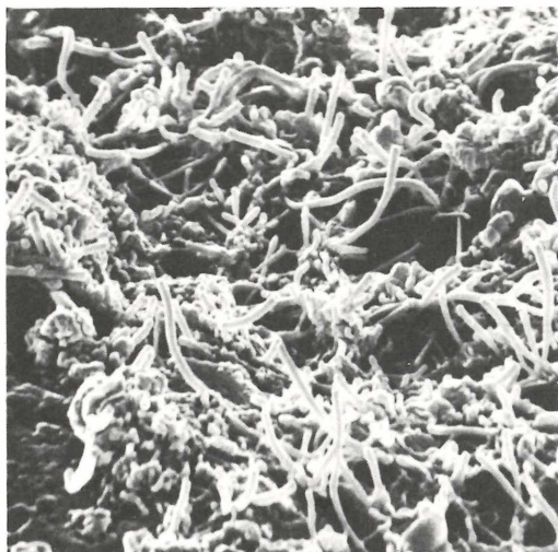
Abb. 5: Intensiver Actinomyceten-Befall im Fischschiefer von Bolca. REM-Foto 6189, Vergr. 4000 X.
