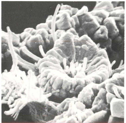
Abb. 16: Vergleichbare Actinomyceten-Hyphen im Unterthion-Merger von Langelaltheim (Coccolith: Cyclagelosphaera ). REM-Foto 2-371, Vergr. 8500 X.
