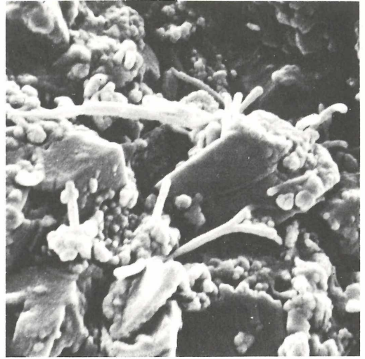
Abb. 14: Die unterschiedliche Korngröße und -form zwischen den neomorphen Matrixkristallen und dem gerundeten Minimikrit lassen zwei voneinander unabhängige Karbonatbildungsphasen erkennen. REM-Foto 6268, Vergr. 8200 X.
