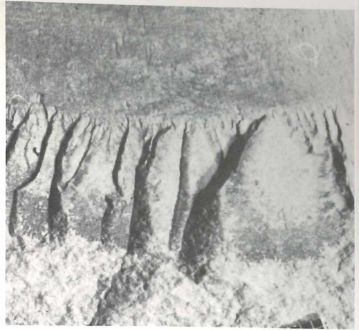
Abb. 7 Dendriten folgen den Lanzettbrüchen
