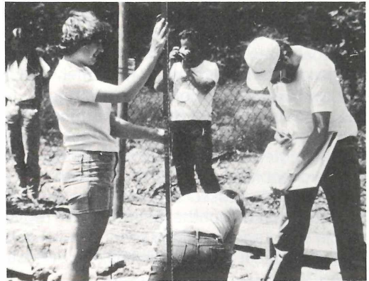
Abb. 6 Nivellieren und Übertrag der gemessenen Höhen in den erstellten Fund- und Befundplan.
