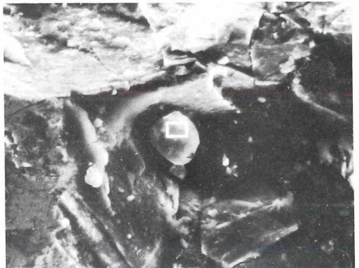
Abb. 4 Bildbreite: 0,051 mm Einzelpartikel innerhalb der Reaktionszone. Die Analyse ergab eine auffallend hohe Konzentration lithophiler Elemente innerhalb des markierten Rechtecks.
