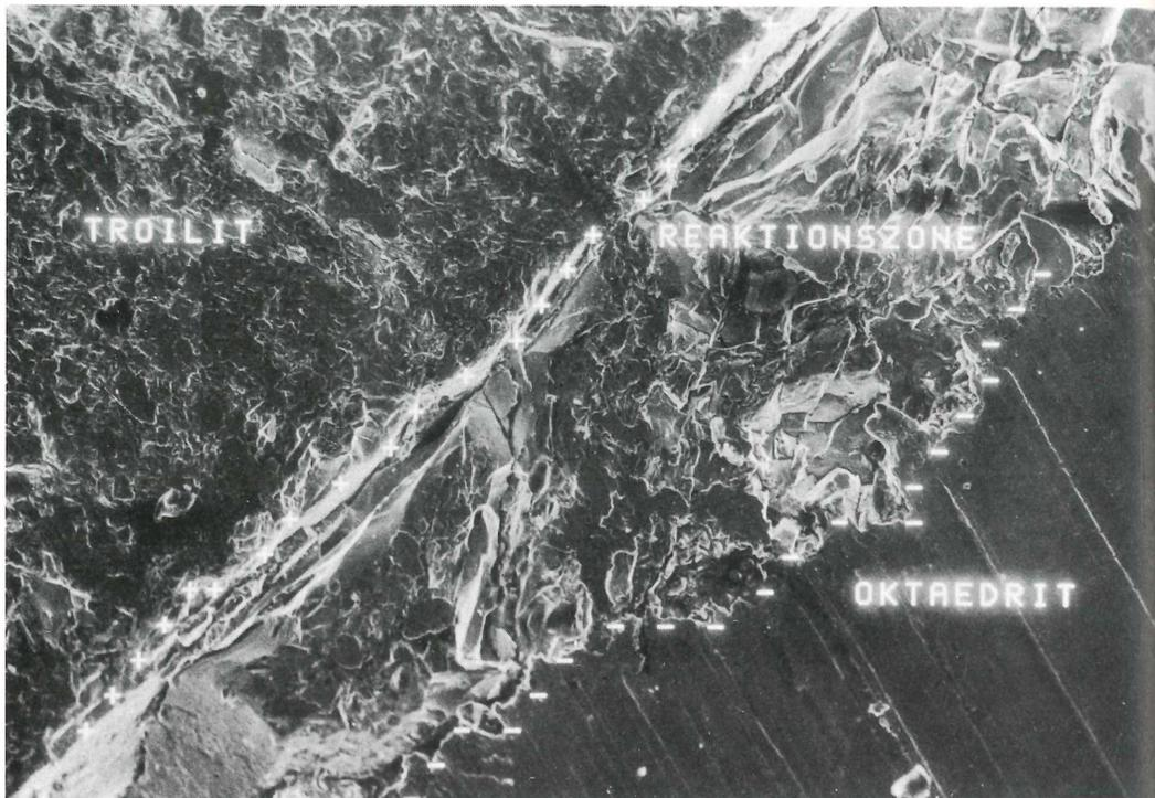
Abb. 2 Bildbreite = 0,633 mm · Der Gegensatz Troilit : Reaktionssaum : Oktaedrit wird in der Vergrößerung besonders augenfällig. Entlang der Einschlusskante, die durch schuppenartig teilweise überlappende Leisten markiert ist, sind hauptsächlich xenomorphe (= fremdgestaltige) Schreibersitkristalle gewachsen. Dieses Bild ist typisch für den randnahen Bereich des Reaktionssaumes. Seine Breite liegt zwischen 0,1–0,2 mm.
