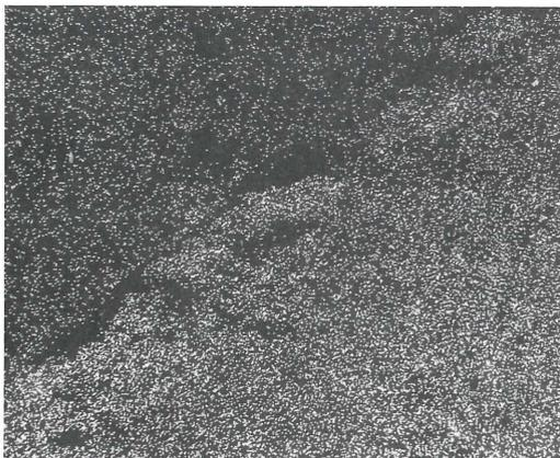
3.1d **Nickel-Verteilung:** Nickel ist kennzeichnender Bestandteil des Nickeleisens im Oktaedrit. Örtliche Anreicherungen im Reaktionssaum sind Schreibersit bzw. Pentlandit zuzuordnen.
