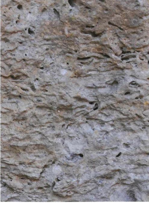
Abb. 14: Links: eine relativ frisch freigelegte Gesteinsoberfläche, an der weitgehend horizontal eingeregelt Schwammrelikte als Grate herausragen. In einigen Fällen sind die porösen Bereiche zwischen den Schwämmen bereits fugenartig ausgewittert – vgl. dazu Abb. 7,8 von der gleichen Lokalität. Rechts: Ältere Gesteinsoberfläche, ca. 2 m über dem auf dem linken Bild dargestellten Ausschnitt. Hinter abgeplatzen, (grauen) biologisch besiedelten Krustenbereichen ist eine hinsichtlich der Durchmesser und Verteilung unregelmäßige Lochverwitterung zu sehen. Das eine oder andere Loch mag seine Anlage möglicherweise auch dem porösen Bereich im Inneren eines umgekippten Schwammes verdanken, doch die Mehrzahl der Löcher dokumentiert ein über das von Schwammresten konfigurierte Gefüge hinausgehendes Wachstum. Weite Bereiche der Oberfläche sind außerdem durch eine strukturierte Kruste stabilisiert. – Mittleres Kimmeridge, Ortsmitte Obertrubach, Trubachweg Pkt. 2 (GK25 Betzenstein)
