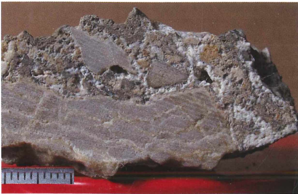
Abb. 22: Probe aus Lokalität Abb. 21. Der Dolomit aus dem Abschuppungs-Bereich ist teilweise in eine von Calcit zementierte Brekzie aufgelöst (weiß: Calcit). Die Calcit-Kristallisationen betreiben zugleich aber auch das Aufbrechen des Dolomits: die Risse in der unten gelegenen Dolomitscherbe sind bereits davon durchsetzt (die Risse sind vermutlich als Drucklösungs-Suturen angelegt). Diese zweifache Wirkung des Calcits sorgt dafür, dass der Dolomit nicht in einzelne Scherben zerfällt, sondern in mehr oder weniger kohärenten Schalen abbricht. – Maßstab 10 mm
