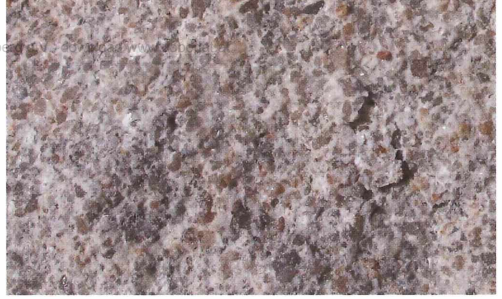
Abb. 6: Dolomitische Arkose des Mittleren Bursandsteins: überwiegend grobe Quarz- und Feldspatkörner sind durch weißen, feinkörnigen Dolomit verbunden. Die Quarze sind durch den Transport zu ihrem Ablagerungsort mehr oder weniger stark kantengerundet. Zahlreiche glitzernde kleine Flächen zeugen allerdings von nach der Ablagerung ankrystallisiertem Quarz. Probe: Lesestein vom kbm-Rücken oberhalb Thüngbach nördl. Schlüsselfeld. Bildbreite ca. 8 cm
