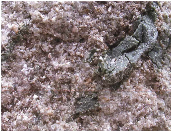
Abb. 5: Nahansicht eines charakteristischen Sandsteins aus dem Unteren Burgsandstein. Die Durchmesser der größeren Quarzkörner liegen um 1 mm. Rechts oben ist ein großer grüner Tonstein-Einschluss zu erkennen. Weiße Körner sind zu Tonmineralen umgewandelter Feldspat. Probenahme an den Kellern östlich Steppach (Steigerwald). Bildbreite ca. 5 cm
