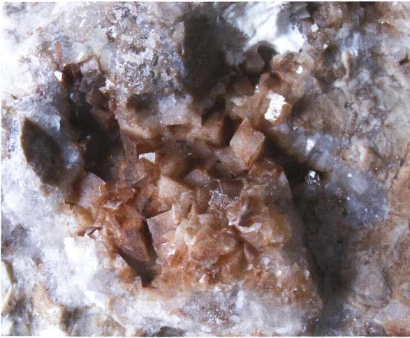
Abb. 8: Insbesondere in den reinen Dolomiten des Mittleren Burgsandsteins findet man nicht selten perfekt auskristallisierte Dolomitekristalle. Die Kristalle erreichen in der abgebildeten Probe Durchmesser bis zu 4 mm. Lesestein aus dem obersten Teil des kbm östl. der Straße Weiher-Vorra, ca. 800 m N-lich Weiher.
