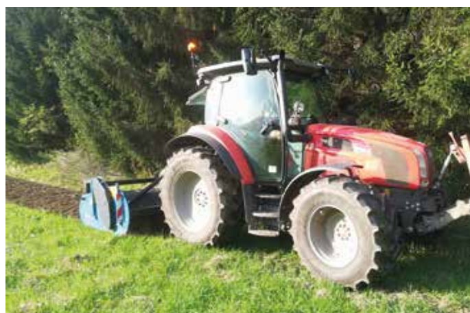
Saatbett-Aufbereitung auf begrünter Fläche mit Imants-EcoMix-Spatenmaschine © LÖCKER (5)
