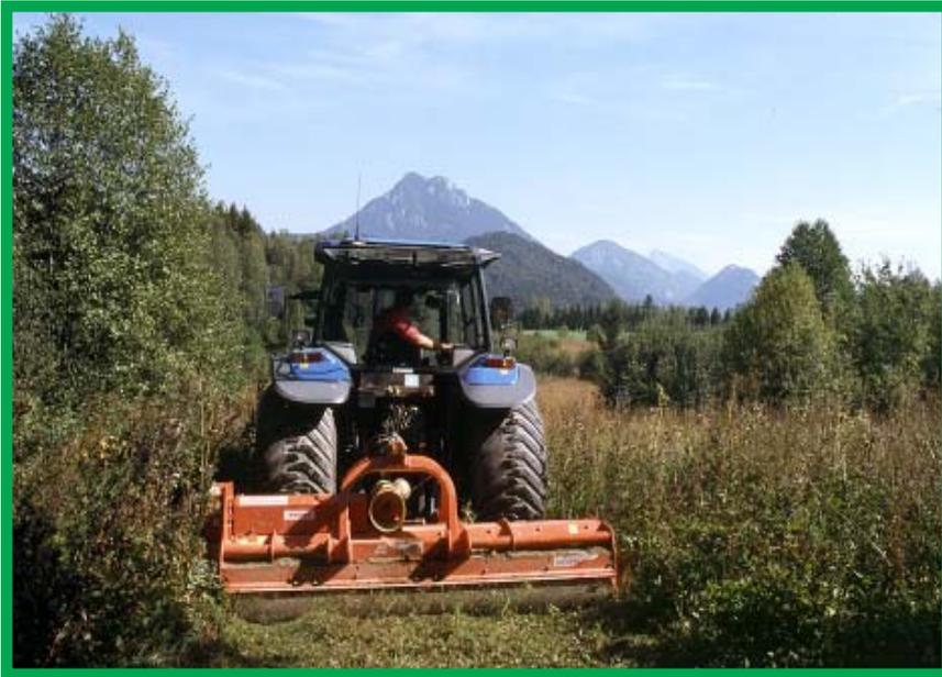
Erstpflge einer seit rund 25 Jahren nicht mehr gemähten, stark verfilzten, aber nur schwach verbuschten Streuwiese mit einem Mulchmäherät im September 2003. Der Traktor ist mit Niederdruckreifen ausgerüstet (Foto: C. Arming)
