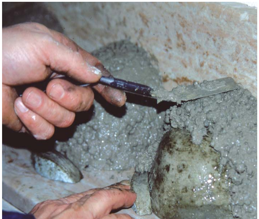
Die Schwalbennester werden vom Naturschutzbund in mühevoller Kleinarbeit hergestellt. Sie bestehen aus einem Gemisch aus Sand, Wasser, Zement, Liapor-Blähtonkügelchen und Sägespänen (Bild: J. Fally).
