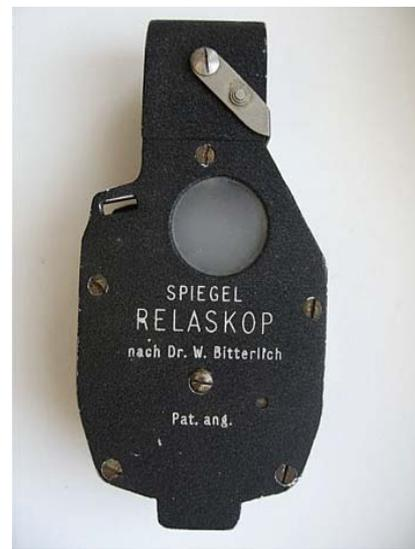
*Spiegelrelaskop von 1955, hergestellt von der Salzburger Firma F.O.B.. Mit dem Spiegelrelaskop können nicht nur „Winkelzählproben“ durchgeführt, sondern dank zusätzlicher Skalen auch Baumhöhenmessungen und Feststellen der Geländeneigung (z. B. zum Straßentrasieren) durchgeführt werden.*
