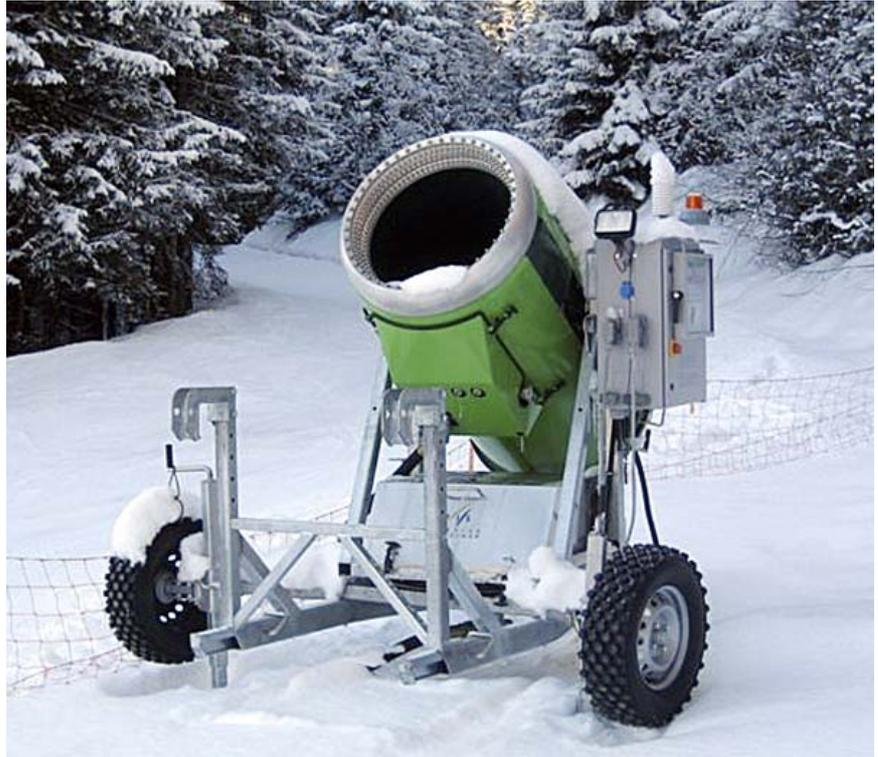
*Niederdruck-Schneekanone fein zerstäubtes Wasser wird in einen Luftstrom eingebracht. Der Energieverbrauch für den Ventilator ist meist beträchtlich.*
