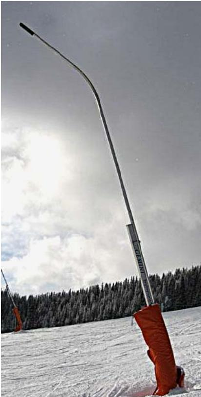
Schnei-Lanzen machen sich die Fallhöhe des Wassers und damit die längere Flugzeit zum Gefrieren des Wassers zunutzen, sind aber empfindlich gegen Windeinwirkung (Bilder: H. Hinterstoisser).
