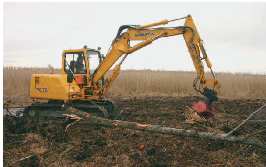
NSG Trumerseen: Wurzelstockentfernung mittels Bagger im Bereich der Überfuhr durch den Maschinenring-Service Flachgau (Bild: O. Stöhr, Jänner 2009).
