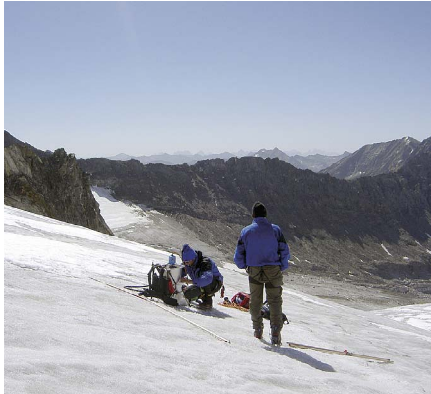
Auf dem drei Quadratkilometer großen Äußeren Mullwitzkees im Nationalpark Hohe Tauern sind 15 Pegelstangen gesetzt, um die Zu- und Abnahme des Gletschereises zu messen. Eine Aufgabe für Forscher mit alpiner Erfahrung (Bild: IMGI).
