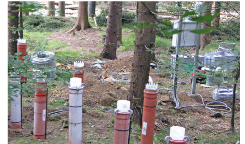
Niederschlags-(Depositions-)sammler. Im Hintergrund Datenlogger und Verkabelungsarbeiten mit den Messgeräten.
