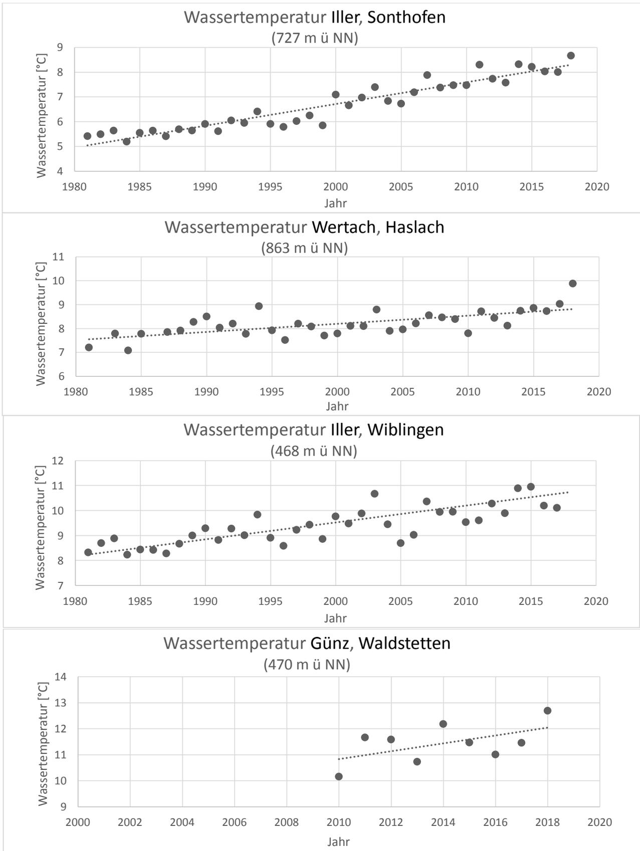
**Abb. 2: Durchschnittliche Wassertemperatur der Iller in Sonthofen und Wiblingen, der Wertach/Grüntensee bei Haslach und der Günz in Waldstetten:** Sie stieg seit 1981 in der Iller bei Sonthofen von 5,0 °C auf 8,4 °C, bei Wiblingen von 8,3 °C auf 10,7°C, in der Wertach/Grüntensee bei Haslach von 7,5 °C auf 8,8 °C und in der Günz bei Waldstetten von 10,8 °C im Jahr 2010 auf 12,0 °C im Jahr 2018.
