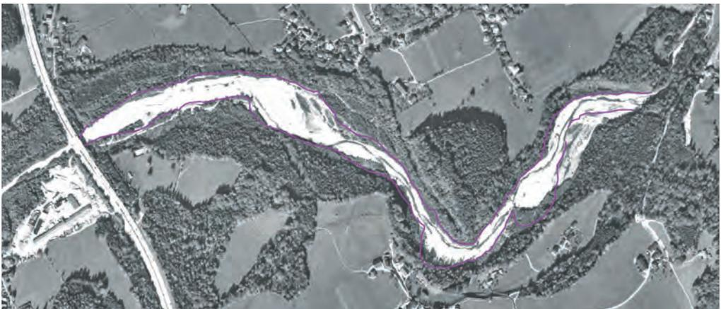
**Abbildung 20:** Orthofoto von der Taugl (Aufnahmejahr: 1995, SAGIS). Das Gewässerbett hat sich stark verschmälert, obwohl kaum Uferverbauungen stattfanden. Durch die starke Geschiebeentnahme hat sich die Taugl innerhalb 40 Jahren von zwischen 3–6 Meter eingetieft
