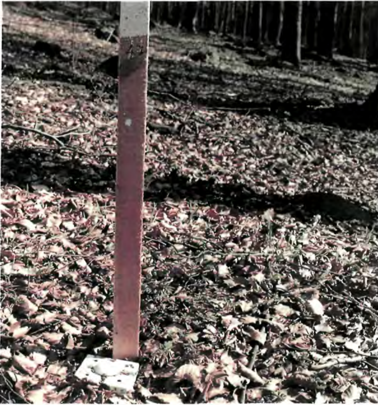
Vermarkung eines Probekreismittelpunktes.
