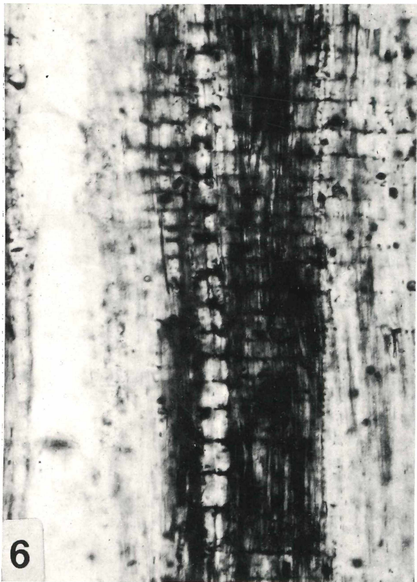
Abb. 6. Radialschliff mit Markstrahlzellen und axial gruppierte Parenchymzellreihe. — Prielhof; Inventar-Nr. 1969 XVIII P 7. 165 x.
