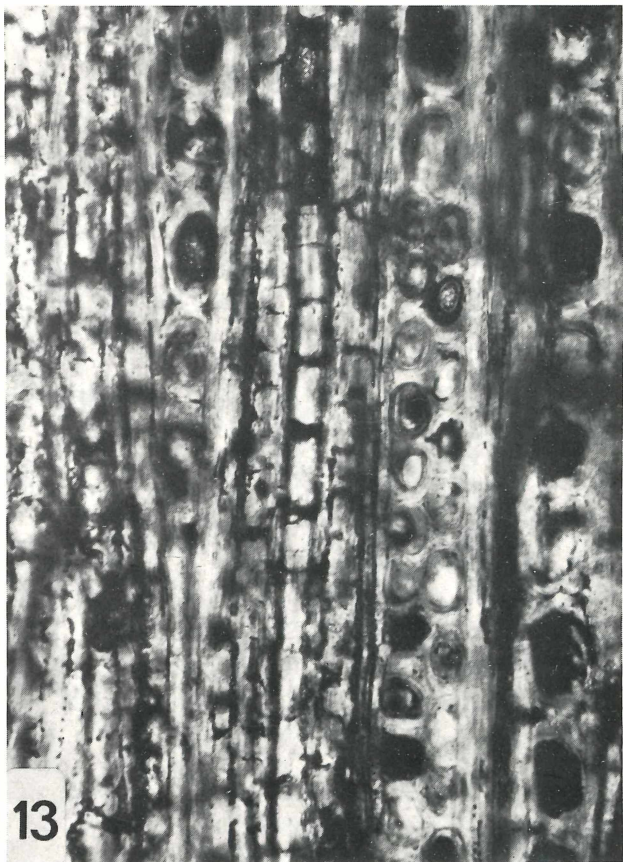
Abb. 13. Tangentialschliff mit kleinen Holzparenchymzellen und Markstrahlen. — Höch; Inventar-Nr. 1972 I 106. 310 x.
