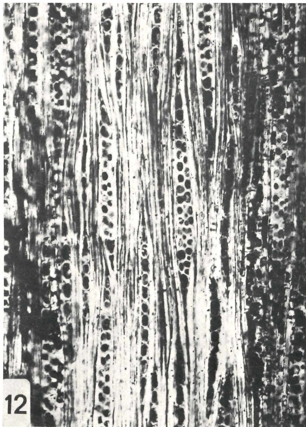
Abb. 12. — Tangentialschliff mit ein- bis zweireihigen Markstrahlen. — Höch; Inventar-Nr. 1972 I 106 t c . 158 x.
