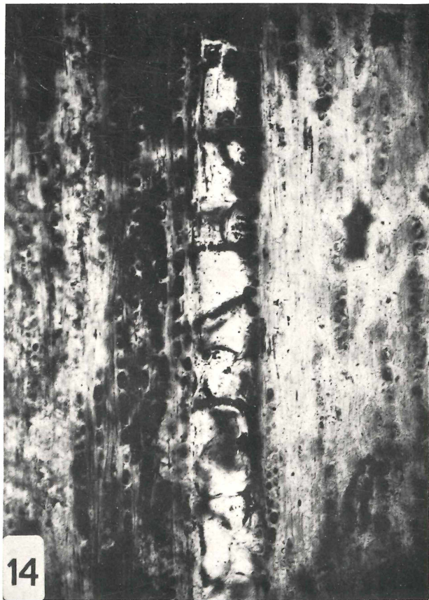
Abb. 14. Tangentialschliff mit Gefäßreihe, Thyllen und Markstrahlen. — Höch; Inventar-Nr. 1972 I 106 t. 108 x.
