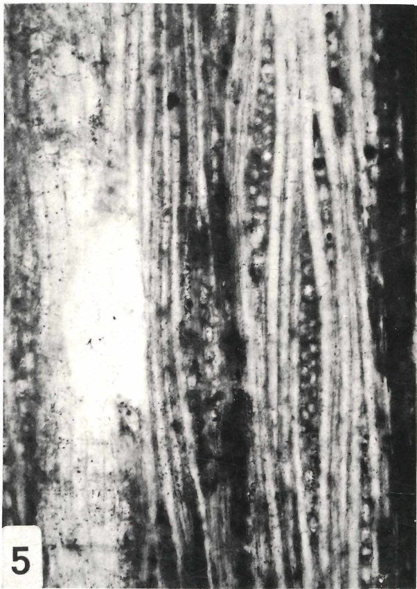
Abb. 5. Tangentialschliff mit ein- und zweireihigen Markstrahlen. — Prielhof; Inventar-Nr. 1969 XVIII P 7. 155 x.
