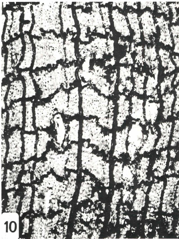
Abb. 10. Querschliff mit stark deformierten Gefäßen, Libri- form, Parenchymbänderung und Markstrahlen. — Höch; In- ventar-Nr. 1972 I 106. 96 x.
