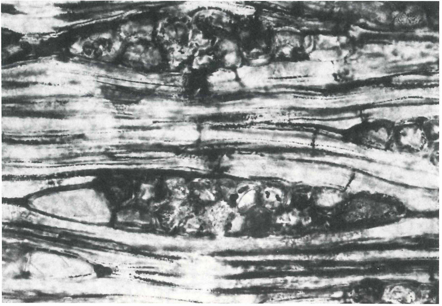
Abb. 11 Tangentialschliff. Holzstrahlen mit Kantenzellen und Librifasern. x 245
