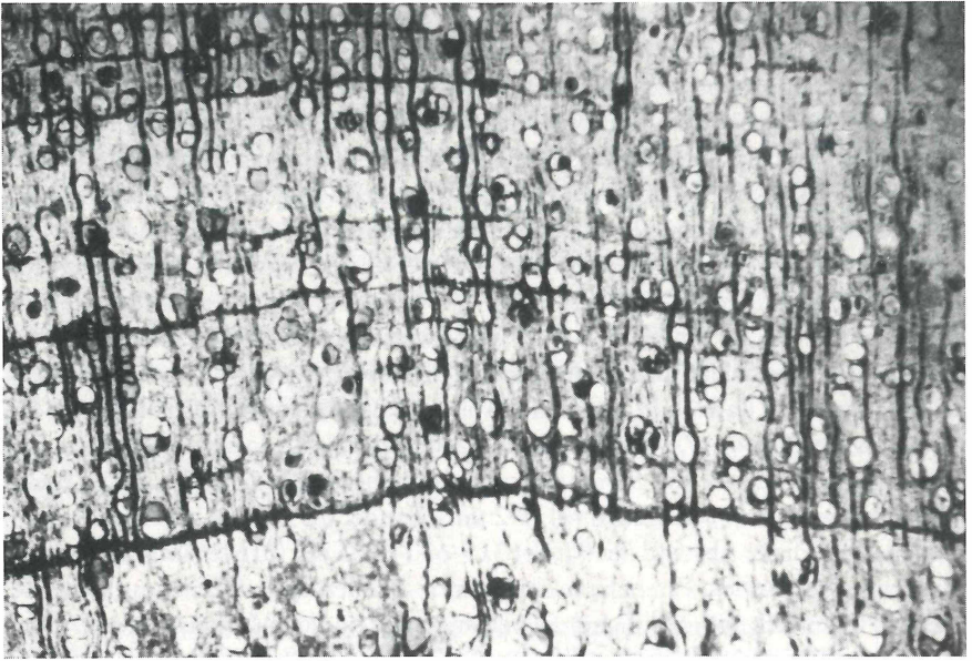
Abb. 2 Querschliff. Zuwachszonen unterschiedlicher Breite, Begrenzung der Zonen durch Parenchymbänder. x 15
