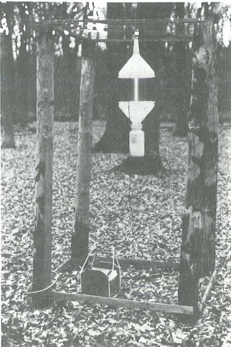
Abbildung 19. Minnesota - Lichtfalle mit Autobatterie als Stromquelle.
