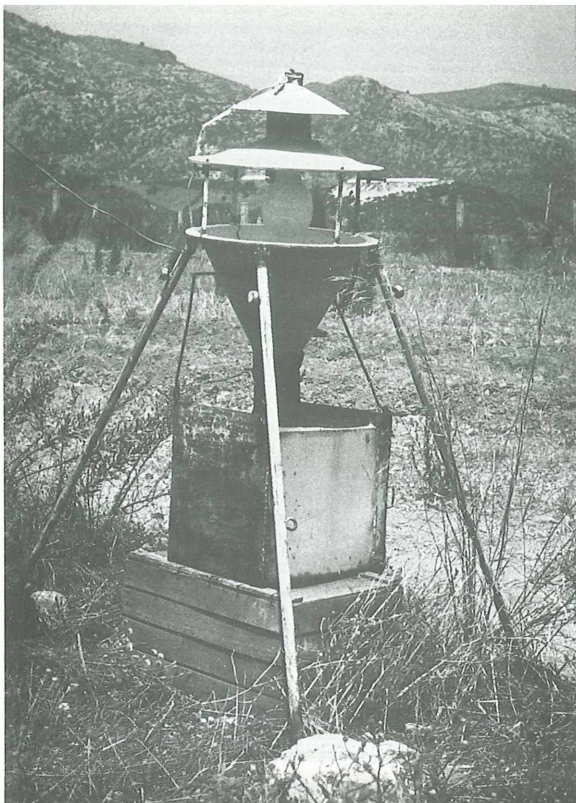
Abb. 10: Lichtfalle von Siniscola mit einer 160-Watt-Mischlichtlampe in der Außenstation des agrarentomologischen Institutes der Universität Sassari.
