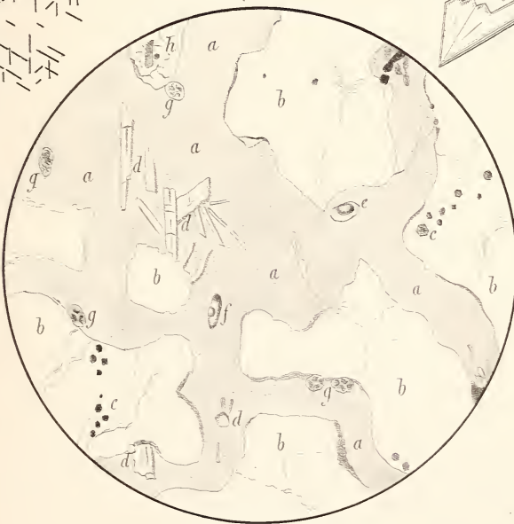
Fig. 5. Gneiss-Einschluss, verglast aus Lephelinit von Oberbergen. a. sehr lichtbräunliches Glas. b. Quarz mit dihexaedrischen Glasporen (c, d.). Augit e. Glaseinschluss mit Bläschen. f. Flüssigkeitseinschluss mit Bläschen. g. entglaste Glaseinschlüsse h. Glimmer und Feldspath.
