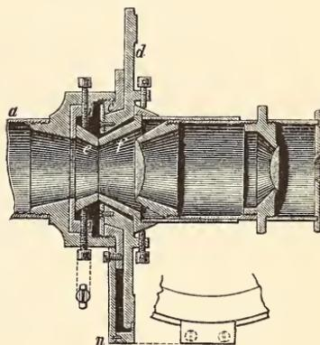
Zur Messung dieses Winkels dient ein von R. FUESS in Berlin construirtes Oculargoniometer<sup>1</sup>.
