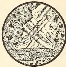
Epidotkrystalle in einem Anorthitkorn (Corsit) von S. Thomas im polaris. Licht. e Epidot, a Augit, f Feldspath, gr Grundmasse.
