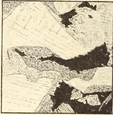
Fig. 12. Mikroklinkorn mit doppelter Randzone.  $\times 125$ .
