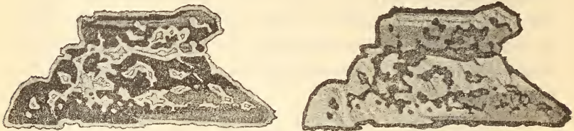
Ein Plagioklaseinsprengling bei + Nicols in 2 verschiedenen Stellungen. Die Feldspathmasse der schmalen Randzone ist ebenso orientirt wie die der Einschlüsse, aber anders als die des Wirthes.
