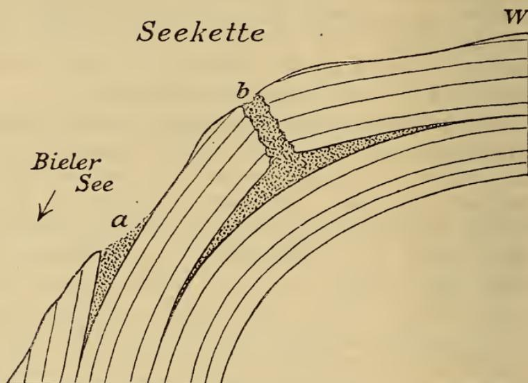
Fig. 1. Schematische Darstellung der abnormen Einschaltungen im unteren Valengien am Bieler See. *a* = keilförmige Einschaltung; *b* = linsenförmige Einschaltung, nach oben sich in eine Querspaltenausfüllung fortsetzend. Nach den Beobachtungen von BAUMBERGER und SCHARDT, sowie des Verfassers. Maassstab etwa 1 : 200.
