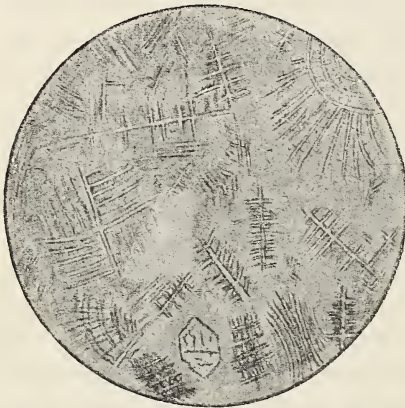
Fig. 2. Diabas mit dendritisch-sphärolithischer Grundmasse. Vergrößerung 200.
