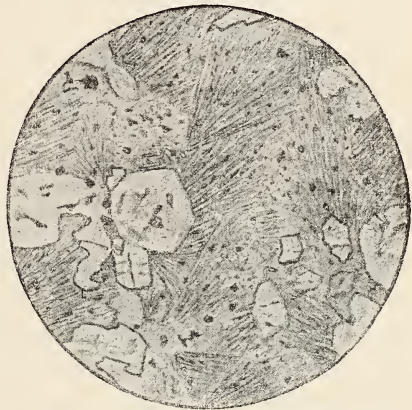
Fig. 1. Diabas mit radialstrahliger Grundmasse. Vergrösserung 45.
