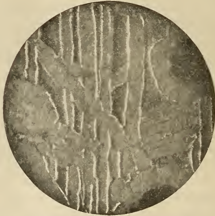
Fig. 10. Hülleisen um Kamacit im Mesosiderit von Rittersgrün. Vergr. 1:12. Sehr schräge Beleuchtung durch Bogenlicht.
