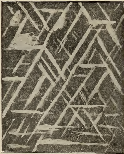
Fig. 3. Oktaedrischer Ferrit mit Perlitfülle. Vergr. 1 : 85. Nach OSMOND.
