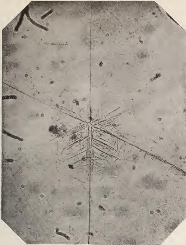
Fig. 4. Schlagfigur des Muscovit; opt. Achsenebene rechts — links; die Winkelunterschiede zwischen den Schlagstrahlen sind ohne weiteres erkennbar; Vergr. 44  $\times$  linear.
