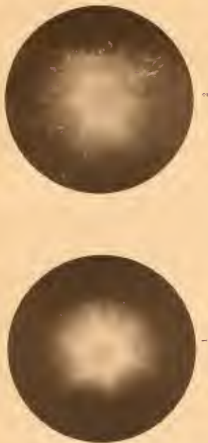
Fig. 1-2. Lichtfiguren von geätzten \alpha -Quarzkugeln. Ätzmittel: \text{Na PO}_3 , Temperatur etwa 700^\circ \text{C} . Pol und Gegenpol einer sechsachsiggen Ase \gamma .
