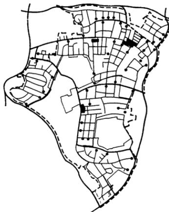
Ein Straßensystem höherer Ordnung trägt den Durchfahrtsverkehr, sorgt für zügigen Verkehrsabfluss und dient zur Entlastung der Verkehrszelle. Nur Zubringerstraßen führen gezielt in diese Zellen. Sie werden derart angeordnet, dass Abkürzungen und Durchfahrten durch das "Environment" nicht zugelassen sind. Fußwegenetze und zentrale Fußgängerzonen sichern zusätzlich gesonderte Bereiche für Fußgänger.
