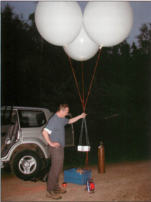
Abb. 2. Helium-Ballons mit Erfassungseinheit. Aufn.: FRANK SCHÄFER
